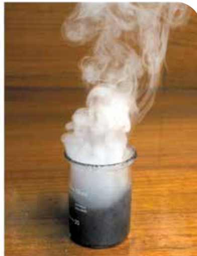
الشكل (8): تفاعل كيميائي بين بيرمنغنات البوتاسيوم وفوق أكسيد الهيدروجين.
