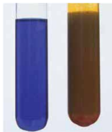
الشكل (18): اختزال أيونات النحاس \text{Cu}^{2+} زرقاء اللون إلى \text{Cu}^+ وترسبها على شكل راسب بني محمّر من \text{Cu}_2\text{O} .
